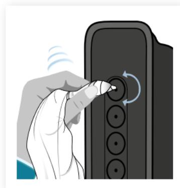
> Nettoyez les aiguilles de l'appareil en formant une pointe avec un chiffon sec et tournez-la dans chacune des optiques ioniques. Répétez l'opération au moins deux fois par an.
