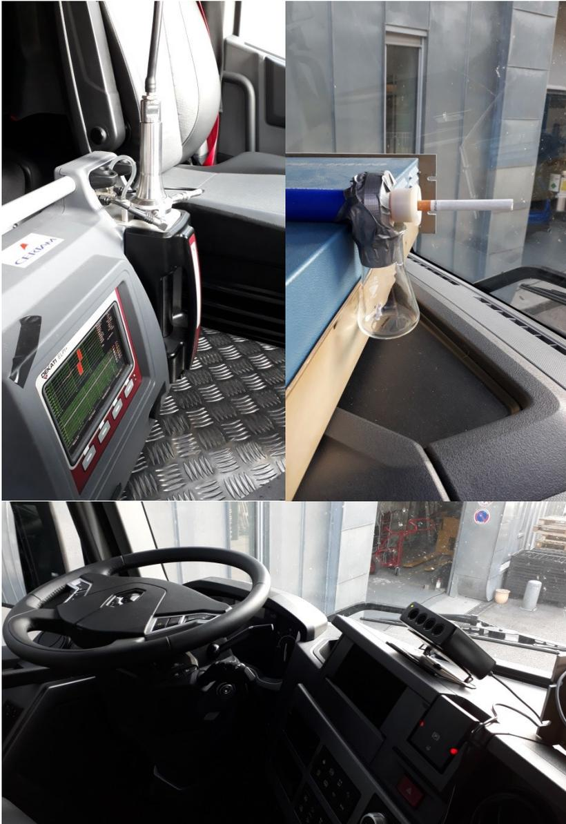
Le suivi de la concentration particulaire dans l'habitacle est monitorée pour ces différentes conditions expérimentales à l'aide d'un granulomètre ELPI+ (Dekati) :
